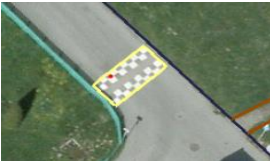
Figur C.2.6e Mätning av farthinder som sluten figur.
